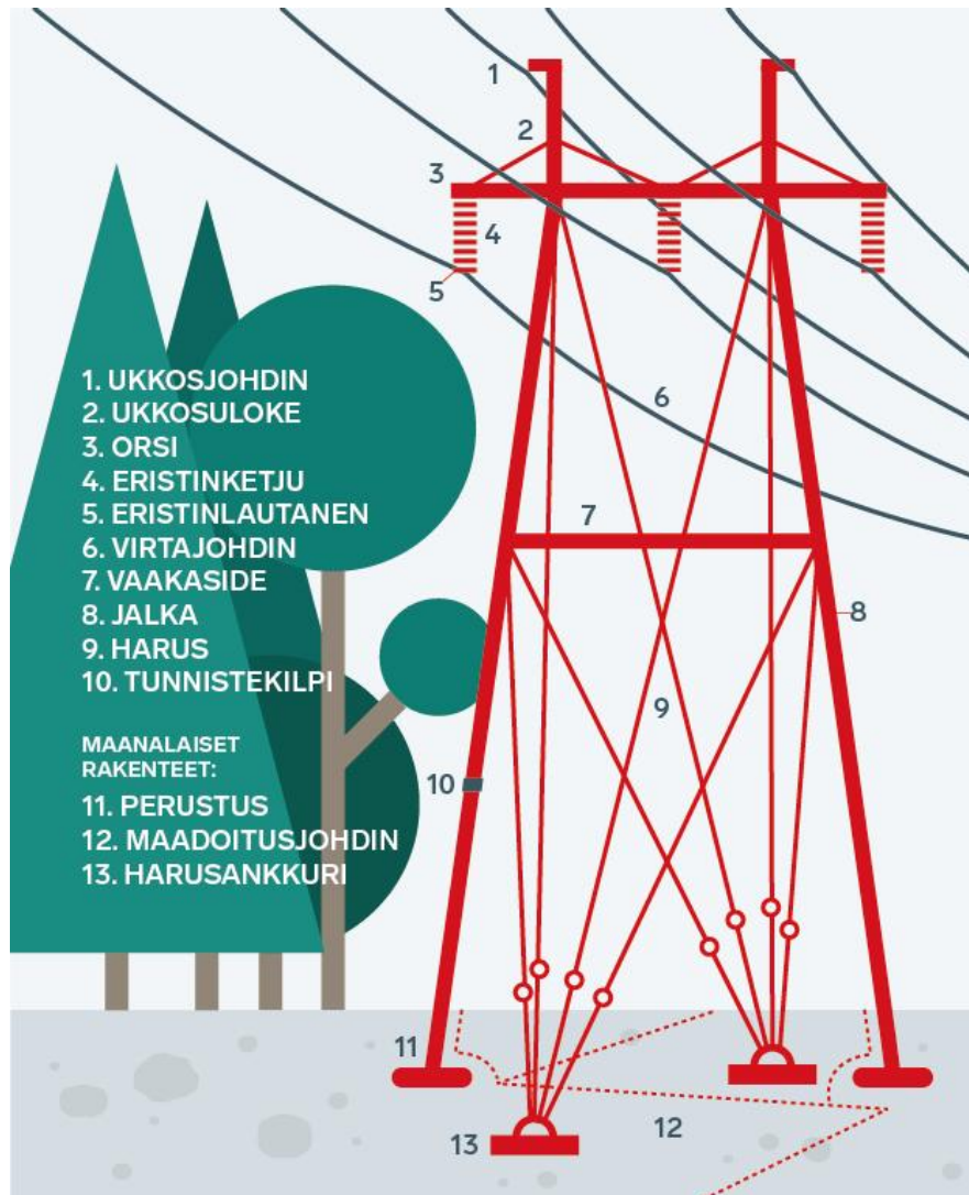
Kuva 6-4. Voimajohtoon osat (Fingrid 2022).
