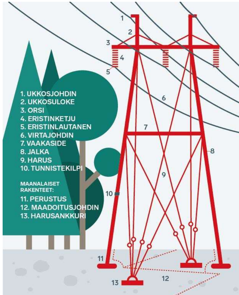
Kuva 6-4. Voimajohdon osat (Fingrid 2022).
